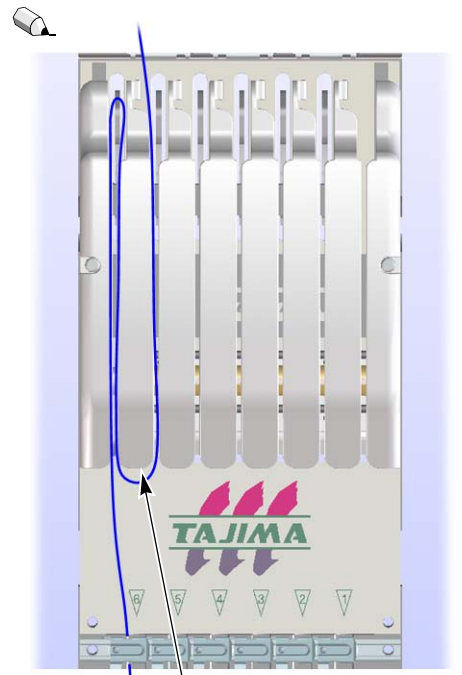
È possibile infilare facilmente il filo agganciandolo qui.
