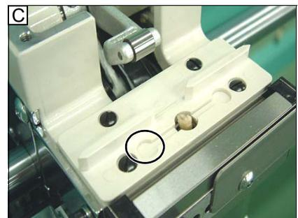
Lubrificare due punti del crochet rotativo. Per lubrificare il foro di lubrificazione 2, collegare l'ugello di lubrificazione accessorio 3 all'oliatore. Tagliare la punta dell'ugello secondo la lunghezza necessaria.
