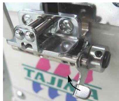
Dopo l'infilatura, riportare la leva nella posizione di base con la vite 1 è rivolta verso la parte anteriore.
