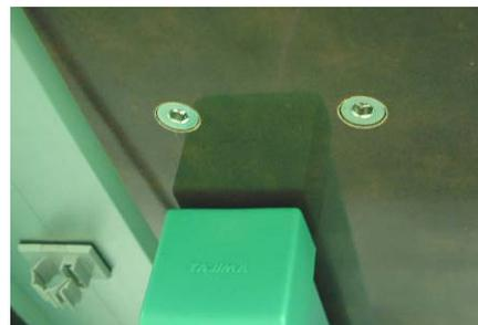
Appoggiare il supporto della tavola sul pavimento, regolare l'altezza con il bullone di regolazione 3 e fissarlo con il bullone 4 (stessa modalità per i tipi A e B).
